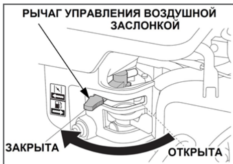
Рис. 14 Рычаг управления воздушной заслонкой (вид сверху)
