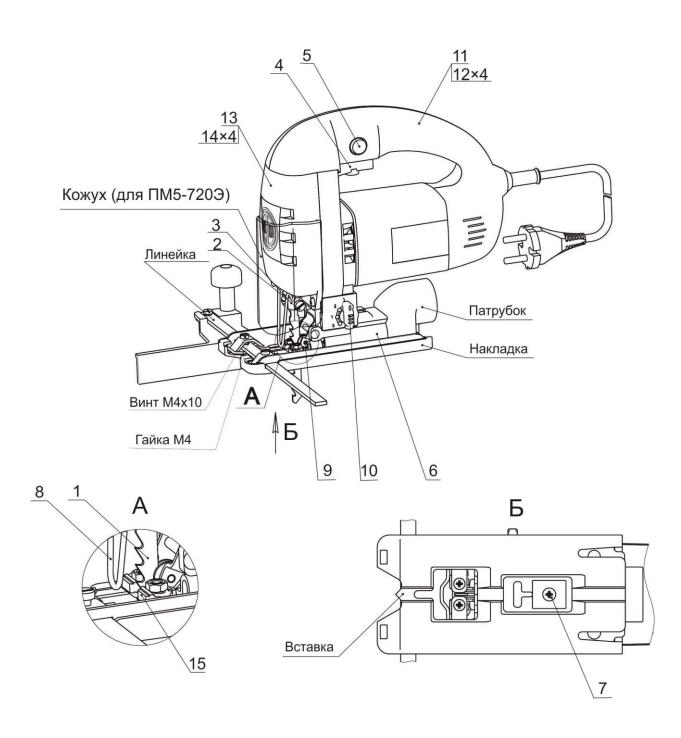
1 - пилка; 2 - винт; 3 - скоба; 4 - клавиша выключателя; 5 - фиксатор; 6 - опора; 7 - винт; 8 - скоба защитная; 9 - ролик; 10 - рукоятка; 11 - ручка; 12 - винт; 13 - крышка; 14 - винт; 15 - вкладыш.
